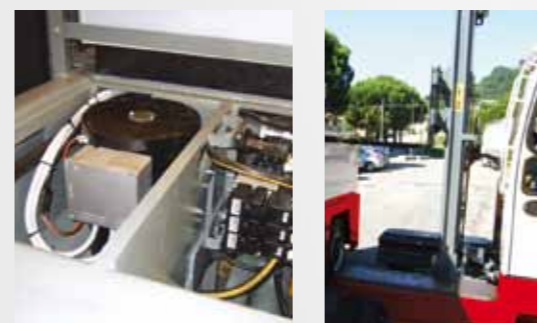
Einige Details des neuen 120 V Systems, welches auf die neuen BAUMANN EGX 50-70 montiert wird.
