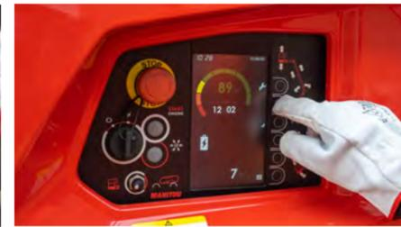
Das große Display an der unteren Station liefert zusätzliche Informationen zur oberen Station. Es ermöglicht den Technikern eine schnelle Diagnose oder die Abfrage des Speichers, dank einer intuitiven Navigation.
