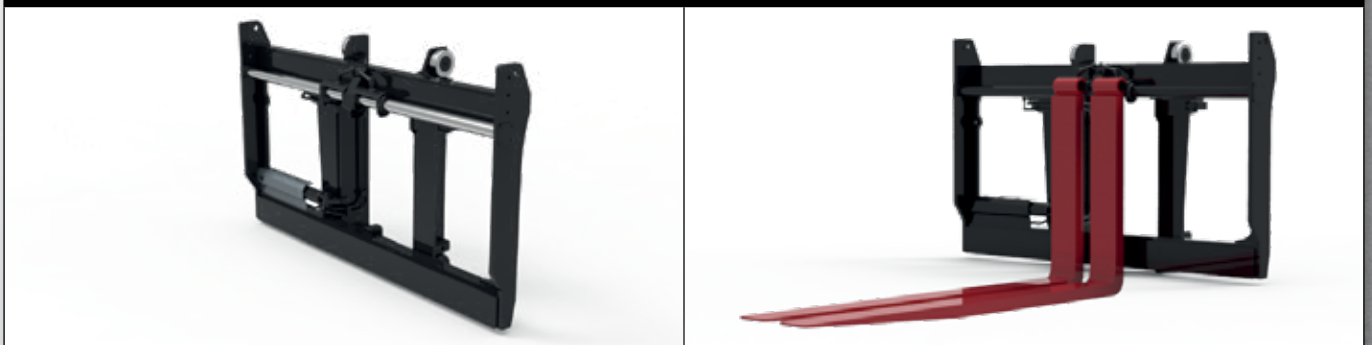
WELLENGEFÜHRTER SEITENSCHUBBRAHMENGABELTRÄGER, 2.396 MM
