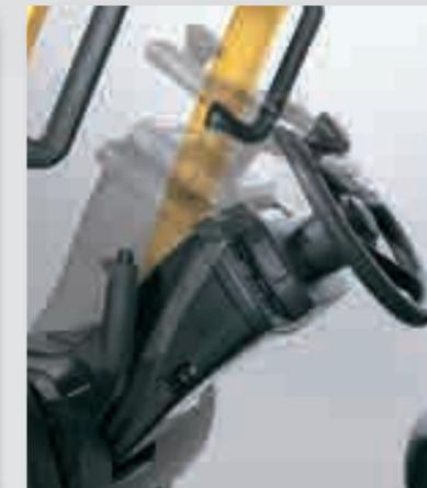
Links: Das standardmäßige Lenkrad mit einem Durchmesser von 30 cm und einem Lenkradknäufel verfügt über eine in der Neigung frei einstellbare Lenksäule.
