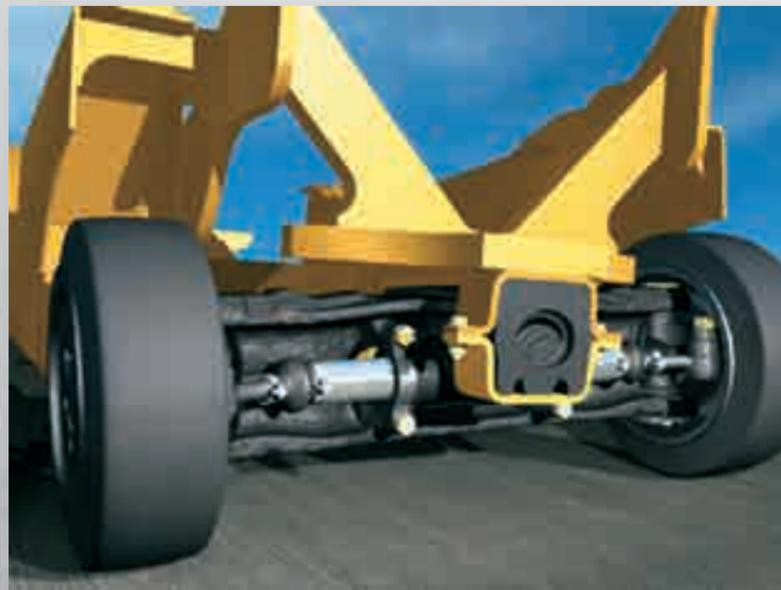
*Oben: Der HSM™ (Hyster Stability Mechanism) vermindert die Seitenneigung von Staplern bei Kurvenfahrt und verbessert so die Seitenstabilität. Die Ausführung gewährleistet ein sichereres Fahren bei unebenen Bodenverhältnissen.*
