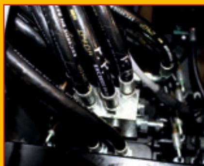
Die Arbeitshydraulik der DFQ-Serie wird von einer leistungsstarken LoadSensing Pumpe gespeist. Dies ermöglicht mehrere Hydraulikfunktionen parallel abzurufen. Der hydraulisch vorgesteuerte Joystick erlaubt dem Bediener, präzise und millimetergenau zu arbeiten. Dieses hocheffiziente Hydrauliksystem stellt Leistung nur dann zur Verfügung, wenn sie gebraucht wird. Das Ergebnis ist ein reduzierter Kraftstoffverbrauch. Ein kluges Design, das Ressourcen spart und die Umwelt schonst!
