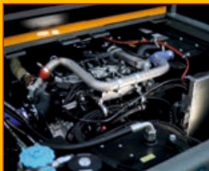
Die DFQ-Serie verfügt über einen leistungsstarken, hocheffizienten Dieselmotor aus dem Hause HATZ. Der 2,0l Stufe V – Motor hat eine Leistung von 55 kW und ist mit einem Dieselpartikelfilter (DPF) und einem Dieseloxidationskat (DOC) ausgerüstet. Die Zugabe von AdBlue ist nicht nötig.
