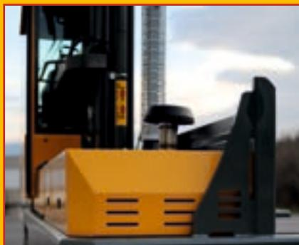
Um Beschädigungen des Motors und des Antriebssystem bei staubigen Einsätzen zu vermeiden, sind sämtliche Luftein- und auslässe oberhalb der Plattform angebracht. Robuste Abdeckungen schützen vor Beschädigungen durch überstehendes Ladegut.
