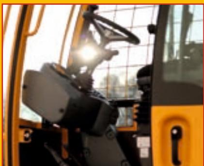
Die neuen Deluxe-Panoramakabinen der Baumann DFQ-Serie bieten rund 20% mehr Platz, als die in der Vergangenheit aufgebauten Varianten. Die vibrationsfrei, mittels großer Hydrolager vom Chassis abgekoppelten Kabinen machen zusammen mit hochwertigen Fahrersitzen den Baumann DFQ zu einem komfortablen und ergonomischen Arbeitsplatz.
