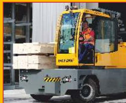
Der EFQ verfügt über zwei Antriebsmotoren und eine 120 V Batterie mit großer Kapazität und langer Laufzeit. Die Ausstattung mit einer geräumigen Panoramakabine, LED-Beleuchtung, einer leistungsfähigen LoadSensing-Hydraulik und dem VRS-System machen den Baumann EFQ zu einer echten Alternative zum verbrennungsmotorischen Seitenstapler.
