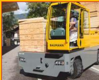
Die hydraulisch kontrollierten Pendelachsen gleichen permanent Unebenheiten auf den Fahrwegen aus. Plattform und Last bleiben sicher und stabil in der Waagerechten. Eine Reduzierung der Fahrgeschwindigkeit bei Kurvenfahrt und das optionale SafeLoad-Assistance machen den Baumann EFQ zum sichersten Seitenstapler seiner Klasse.
