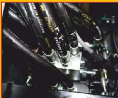
Die EFQ-Serie nutzt eine leistungsstarke LoadSensing-Pumpe in Kombination mit einem Flowsharing-Ventil. Dieses hocheffiziente Hydrauliksystem stellt Hydraulikleistung nur dann zur Verfügung, wenn sie gebraucht wird. Das Ergebnis ist maximale Energieeffizienz. Ein kluges Design, das Ressourcen spart und die Umwelt schont.
