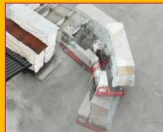
Mit einer Gesamtlänge von nur 3.980 mm und einer Fahrzeugbreite von 1.950 mm ist der Baumann ELQ die wohl kompakteste und wendigste Maschine am Markt. Auch die Tischhöhe von lediglich 750 mm machen die ELQ-Serie zum Star in jedem Lager.
