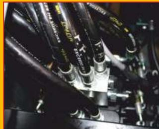
Die ELQ-Serie nutzt eine leistungsstarke LoadSensing-Pumpe in Kombination mit einem Flowsharing-Ventil. Dieses hocheffiziente Hydrauliksystem stellt Hydraulikleistung nur dann zur Verfügung, wenn sie gebraucht wird. Das Ergebnis ist maximale Energieeffizienz. Ein kluges Design, das Ressourcen spart und die Umwelt schont!
