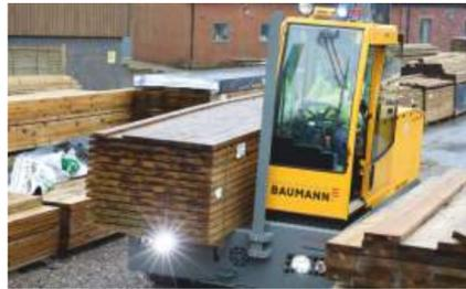
Zwar wird die Last in der Regel auf der Plattform liegend verfahren, hängt das Ladegut aber durch, erfordert schon die Aufnahme aus dem Regal oder vom Trailer einen vergrößerten Gabelabstand oder sogar ein zusätzliches Gabelpaar an den Außenkanten der Traverse.
