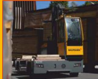
Mit über 8 Stunden ununterbrochener Betriebszeit pro Batterieladung, der vibrationsfrei gelagerten Panoramakabine, der leistungsstarken, präzise arbeitenden LoadSensing-Hydraulik, und der straßentauglichen LED-Beleuchtung ist der Baumann ELQ einer der produktivsten und energieeffizientesten Seitenstapler, die je gebaut wurden.
